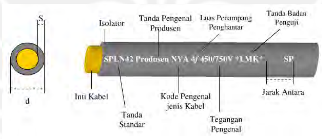
Gambar 3.5. Konstruksi Kabel NYA 1.5 mm 2
